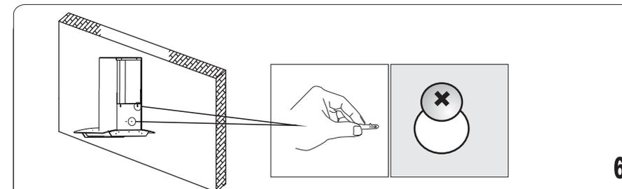
Закрутите 4 винта. Сначала закрутите два верхних винта, затем закрутите два нижних винта.
