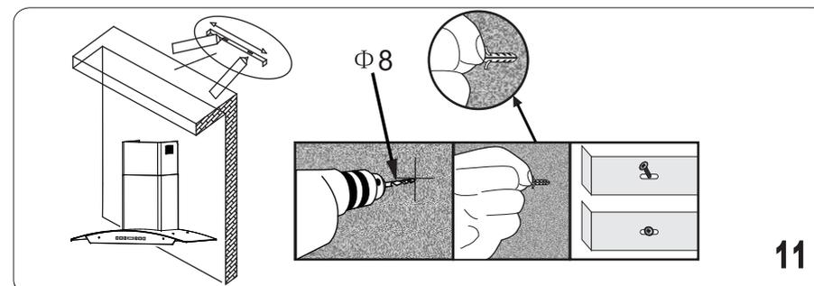
Установите стационарно закрепляемую опору для декоративного короба в соответствующее положение
