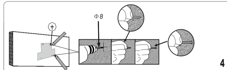
Повесьте вытяжку, и постарайтесь совместить 4 отверстия (под монтаж) с 4 крепежными винтами. Отрегулируйте положение винтов.
