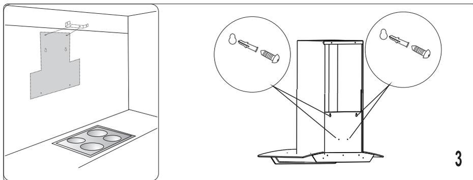
убедитесь в том, что положение вытяжки на стене правильное. Затем с помощью трафарета и дрели выполните на стене четыре отверстия диаметром 8 . Закрепите четыре комплекта расширяющихся заглушек с предназначенными для них винтами в четырех отверстиях.
