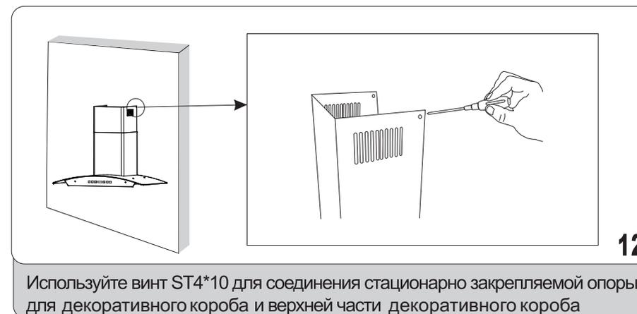
Используйте винт ST4\*10 для соединения стационарно закрепляемой опоры для декоративного короба и верхней части декоративного короба
